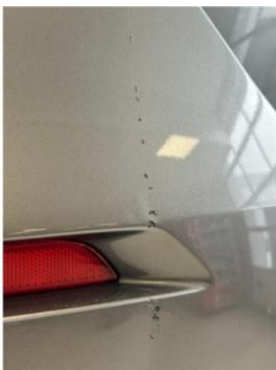
1.2 Noen riper og hakk i fanger bak
