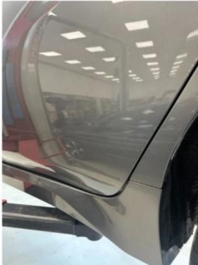
1.1 Noen riper i dør venstre bak. Dempes med rubbing og polering
