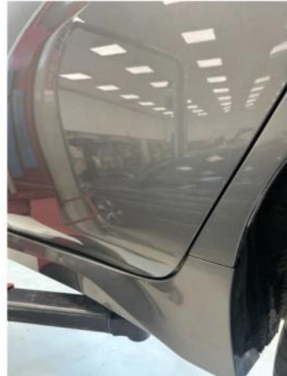
1.2 Noen riper og hakk i fanger bak
