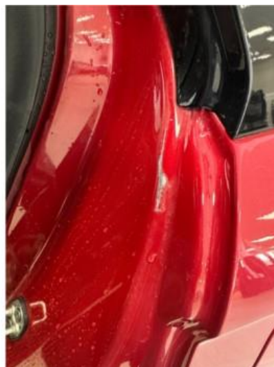
1.2 Noe slitt innsteg i begge dører bak
