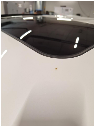
2.6 Steinsprut med rust
