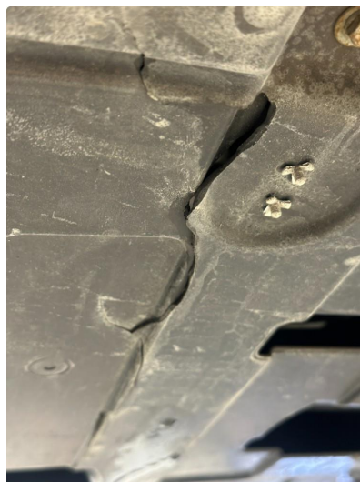
1.1 Noen sprekker i beskyttelsesplate under bilen
