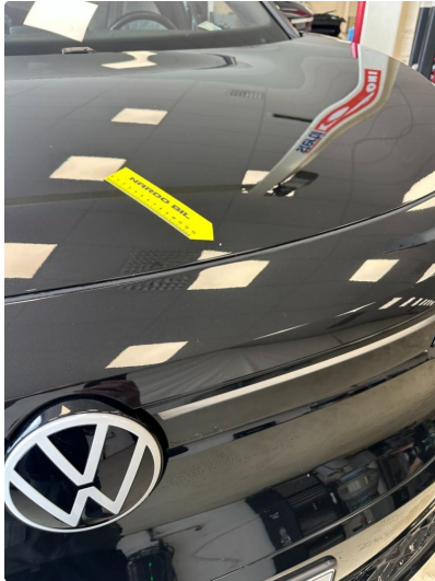
1.1 Liten steinsprut i forkant panser
