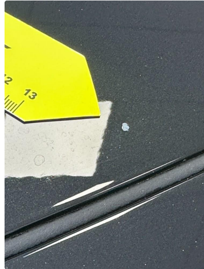
1.1 Liten steinsprut i forkant panser
