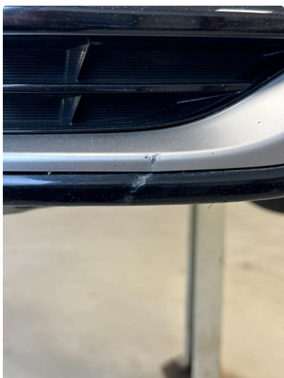
1.2 Noen hakk i nedre del av fanger foran
