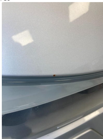
1.1 Små rustflekker i panser. Pusses og flekkklakkeres
