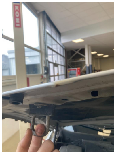
1.1 Små rustflekker i panser. Pusses og flekkklakkeres
