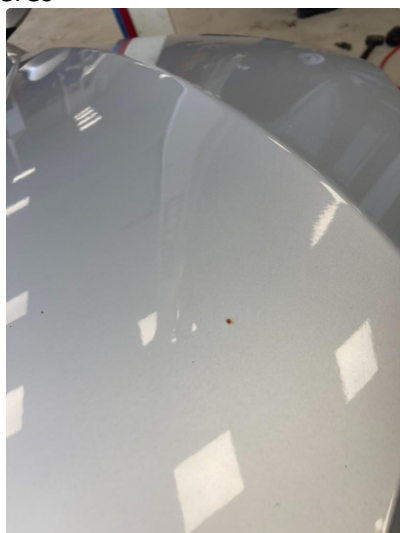
1.1 Små rustflekker i panser. Pusses og flekkklakkeres
