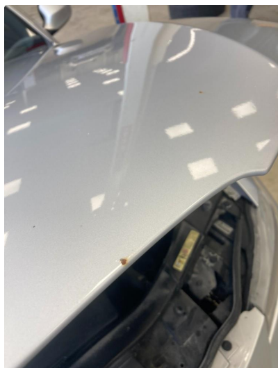
1.1 Små rustflekker i panser. Pusses og flekkklakkeres
