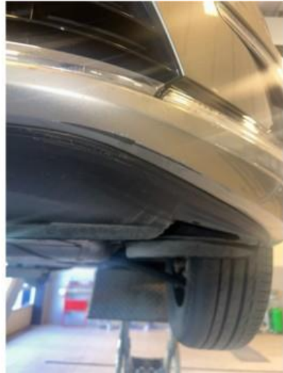
1.3 Liten skubbskade under støtfanger foran
