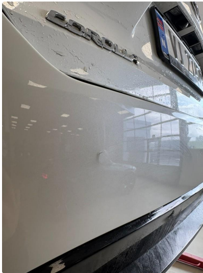
1.2 Liten bulk med lakkskade i fanger bak
