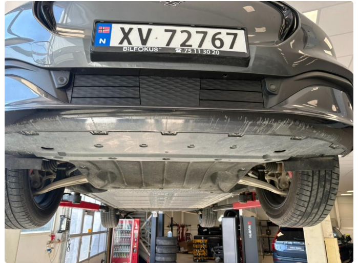
1.2 Noe oppripet på underside av fanger foran
