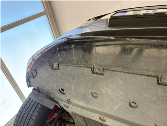
1.2 Noe oppripet på underside av fanger foran
