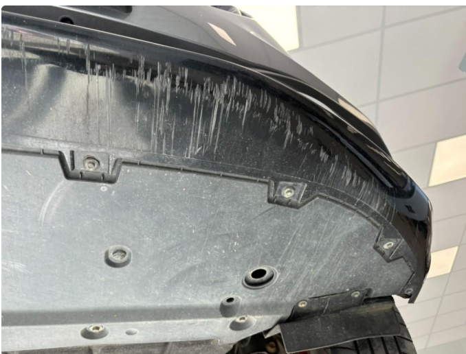
1.2 Noe oppripet på underside av fanger foran
