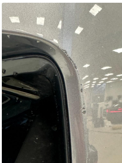
1.2 Noen hakk/riper i nedre del av fanger venstre foran
