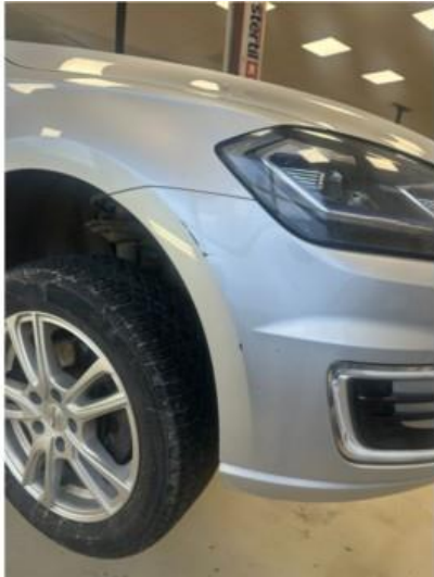
1.2 Noen riper i fenger høyre foran.
