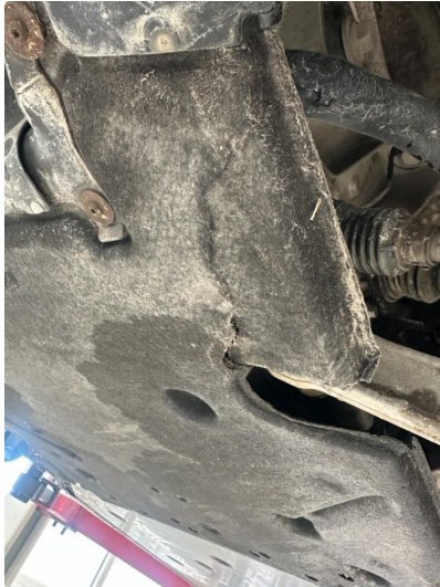
1.1 Liten sprekk i beskyttelsesplate under bil.
