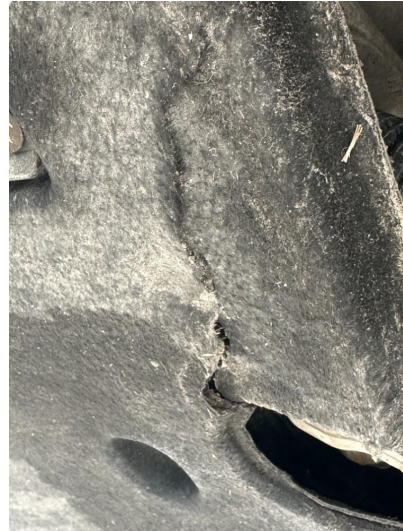
1.1 Liten sprekk i beskyttelsesplate under bil.
