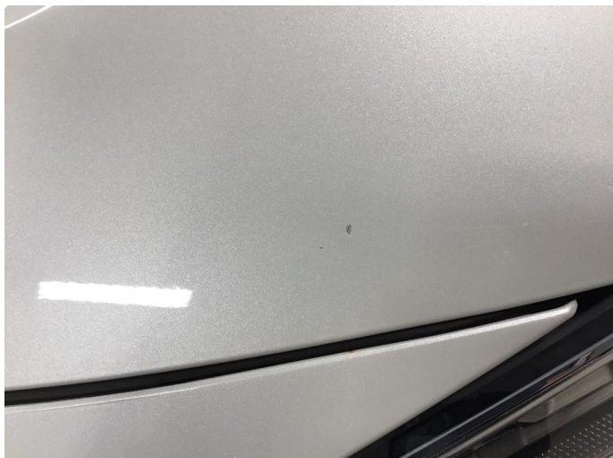
1.1 Steinsprut panser. Svært få
