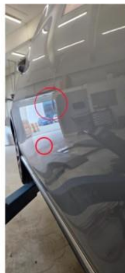
1.2 Små p-bulker og en liten lakkskade på høyre fordør
