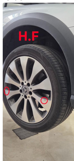
1.3 Påbegynnende oksidering og noen kantkjørte merker på sommerdekk
