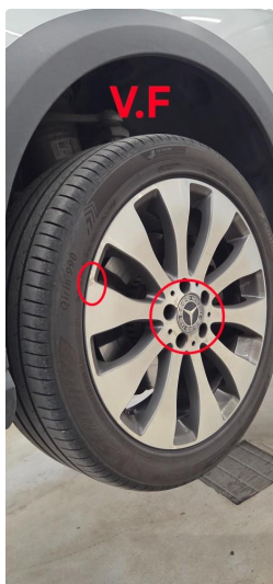
1.3 Påbegynnende oksidering og noen kantkjørte merker på sommerdekk
