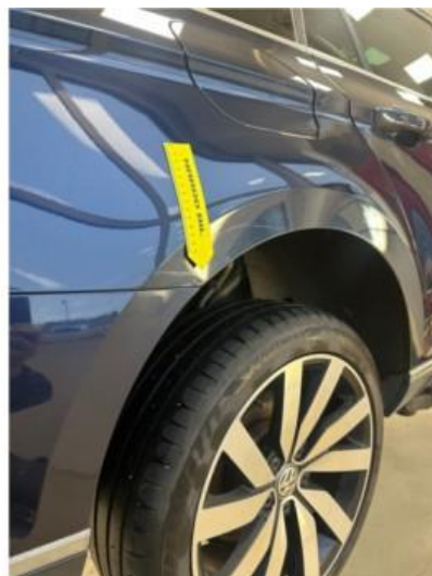
1.2 Lakkskade + ett par små bulker i skjerm venstre og høyre bak
