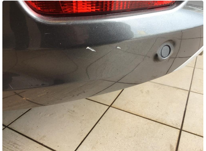
1.4 Lite hakk støtfabger bak
