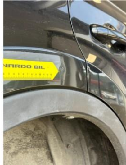
1.1 Noen p.bulker i skjerm høyre bak
