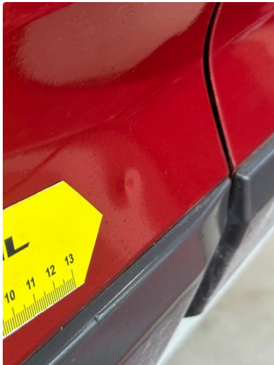
1.1 En p-bulk i dør høyre bak
