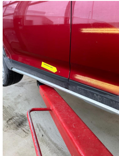
1.1 En p-bulk i dør høyre bak
