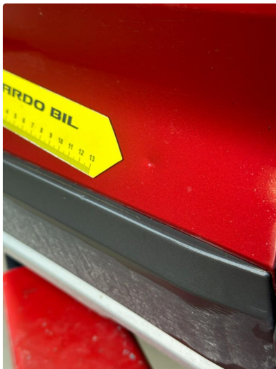
1.1 En p-bulk i dør høyre bak
