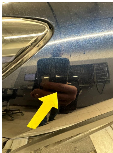
1.4 Ripe(r) ned til grunning
