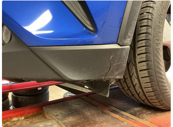
1.4 Sprekk i støtfanger.
