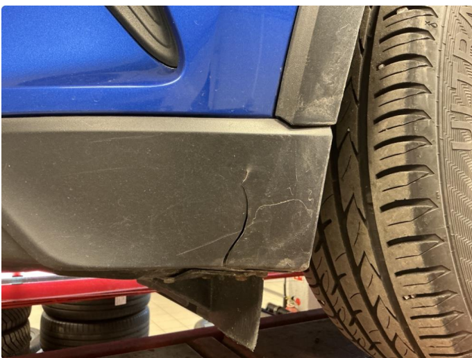
1.4 Sprekk i støtfanger.
