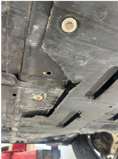
1.1 Noen sprekker i beskyttelsesplate under bilden
