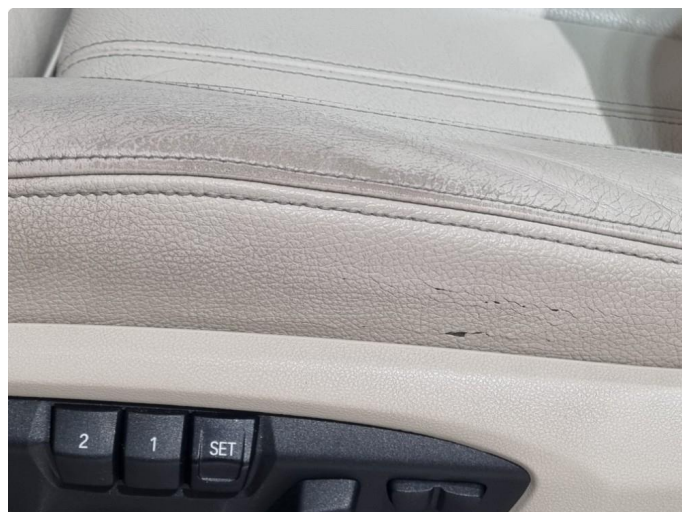
2.2 Noe slitasje på førersete, men ikke unormalt iht kilometerstand
