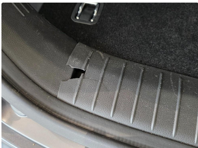
1.3 Skader på begge sider av deksel i lastesone bagasjerom
