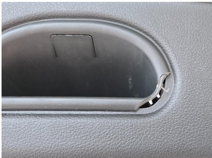
1.1 Skade på lukkehåndtak innvendig
