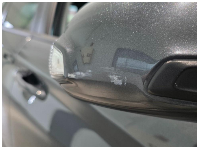
1.2 Lakkskade på speilkåpe
