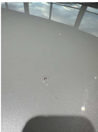
1.4 3 små rustbobler etter steinsprut
