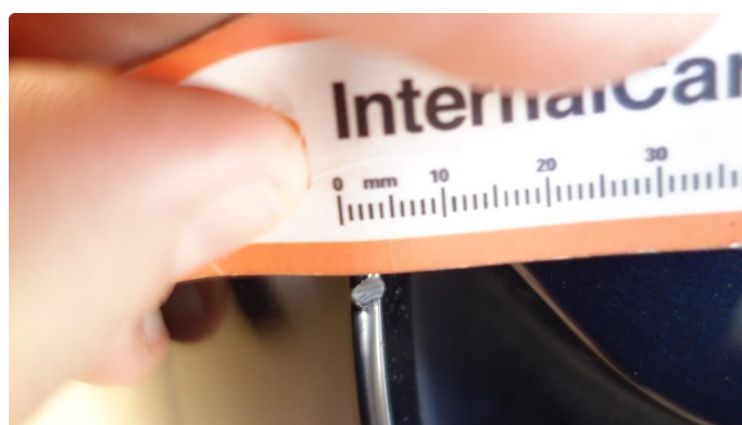
1.2 Hakk riper innlasting bakfanger flekkes og poleres
