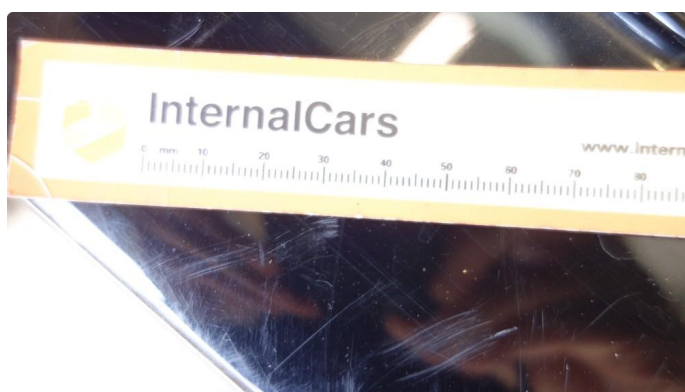
1.2 Hakk riper innlasting bakfanger flekkes og poleres
