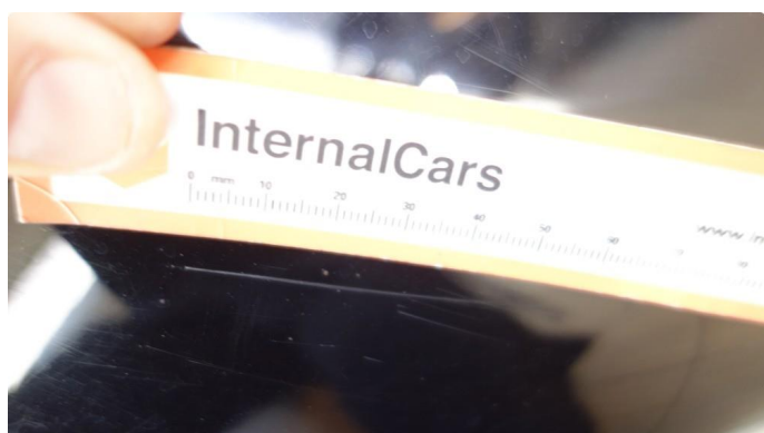
1.2 Hakk riper innlasting bakfanger flekkes og poleres
