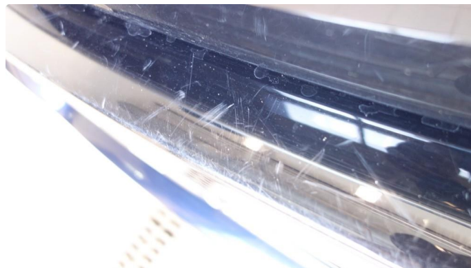
1.2 Hakk riper innlasting bakfanger flekkes og poleres
