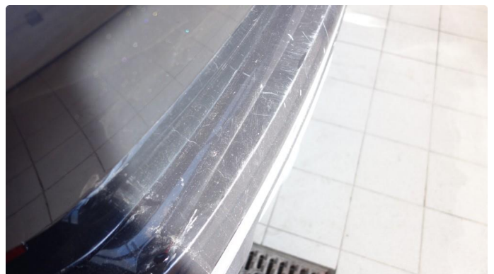
1.4 Ripe(r) ned til grunning
