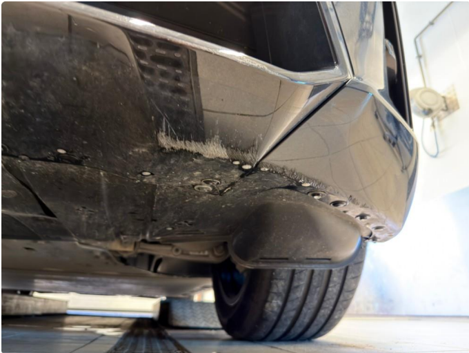
1.1 Ripe(r) ned til grunning
