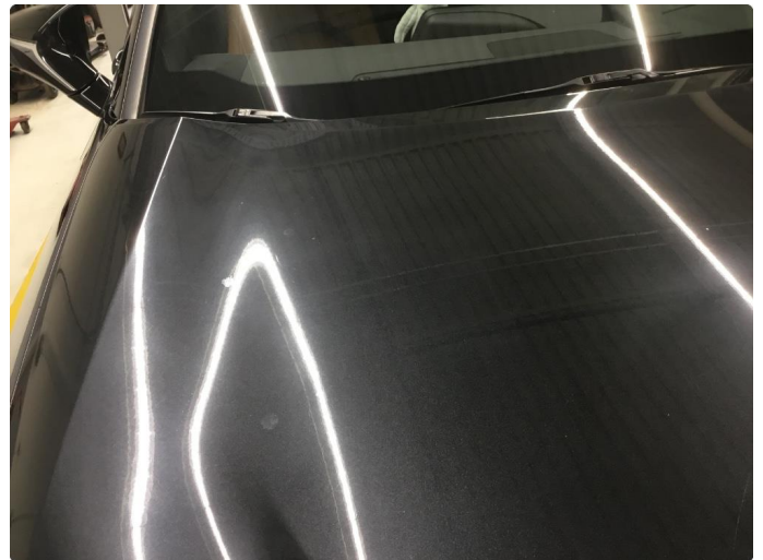
1.1 Ripe(r) ned til grunning
