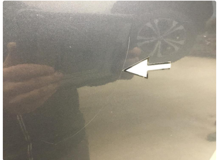
1.1 Ripe ned til grunning
