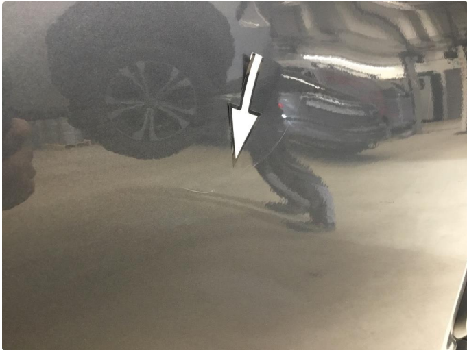
1.1 Ripe ned til grunning
