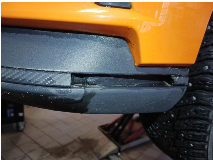
1.3 Merke i nedre del av støtfanger foran.
