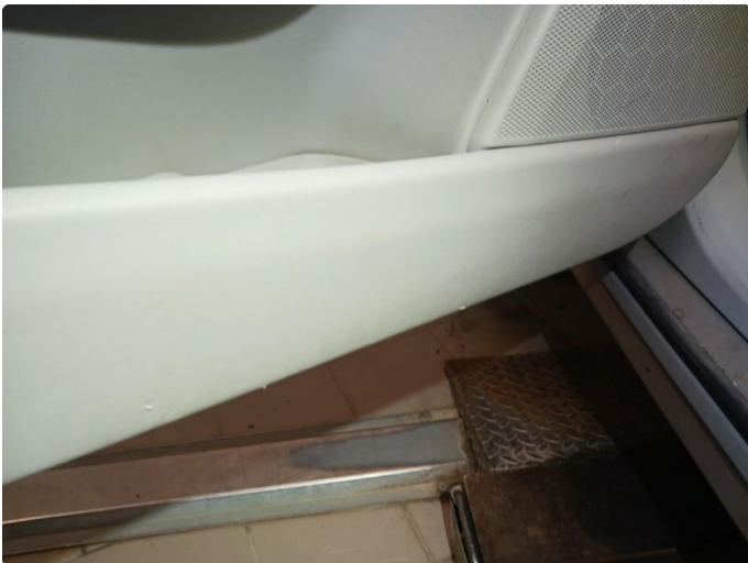
2.1 Noe merker i dørtrekk
