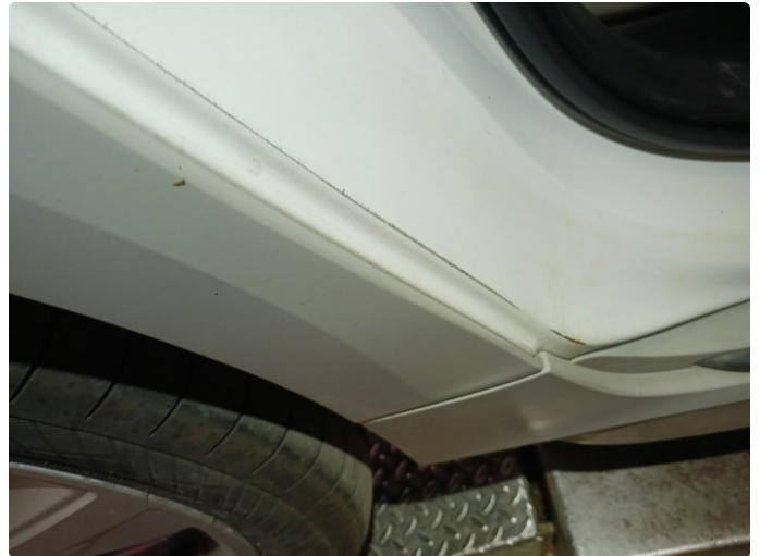
1.2 Noe lakkslitasje innvendig i døråpninger
