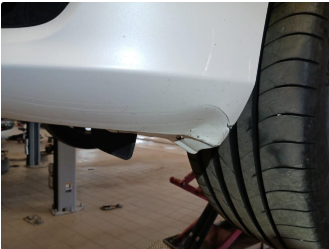
1.3 Merke i underkant av støtfanger
