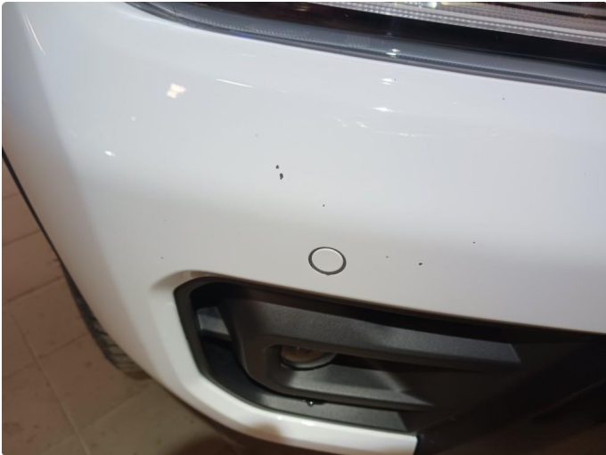
1.1 Noe steinsprut i front, disse blir flekket i.
