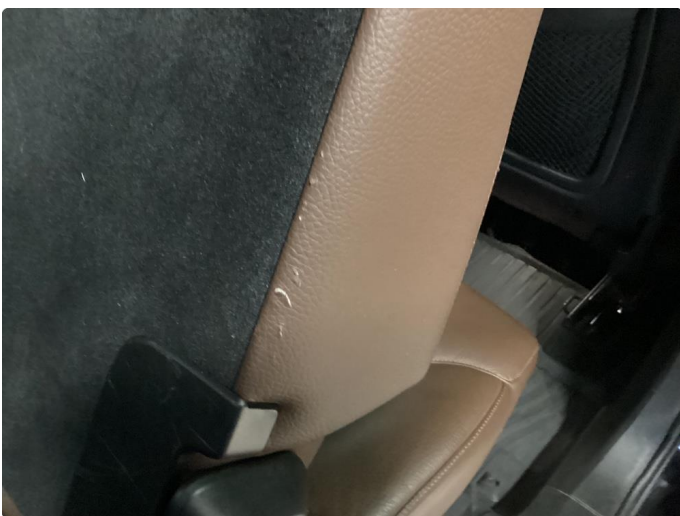
2.1 Skade på setetrekk
