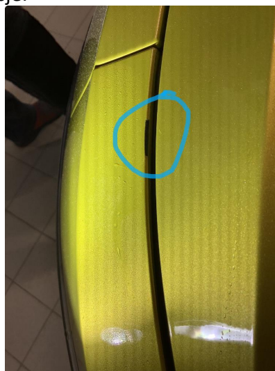
1.3 Noe steinsprut på støtfanger foran. Normal bruksslitasje.
