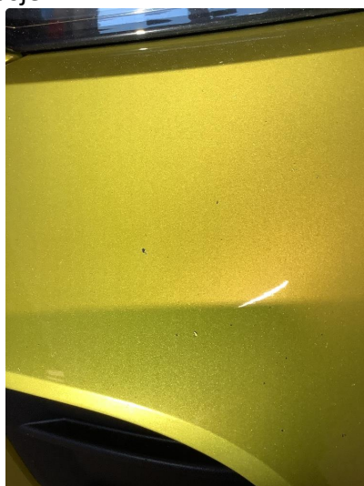
1.3 Noe steinsprut på støtfanger foran. Normal bruksslitasje.
