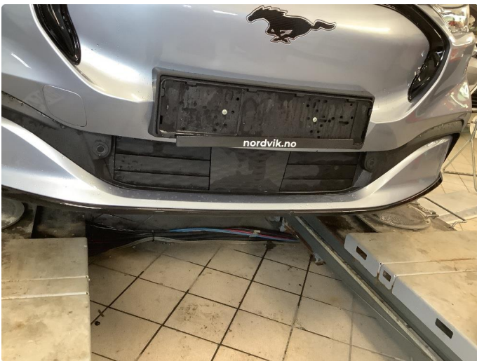
1.4 Liten lakk skade senter nedre del av fanger+ noe steinsprang. Normal bruksslitasje
